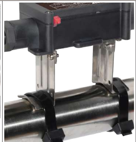
3 : Une platine en acier inoxydable, pour montage décalé sur tuyauterie , permettant l'encliquetage du boîtier après la pose de l'isolation et de sa protection. Permettent une épaisseur d'isolant de 50mm , ainsi qu'une utilisation sur des tuyauteries chaudes. Serrage sur tuyauterie métal ou PVC par serre-câble nylon ou collier de serrage métal. (Pattes disponibles en accessoire.)
