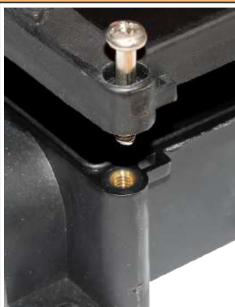
1 : Quatre vis en acier inoxydable imperdables serrant sur des inserts métalliques. Pas de vissage dans la matière plastique, pas de charnières fragiles.
