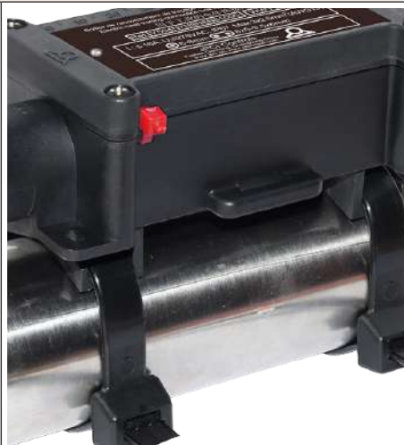
2 : Deux pattes amovibles en matière plastique PA6, pour montage sur tuyauterie , décalant le boîtier de 10mm de la paroi du tube. Idéales et économiques pour les applications avec épaisseur faible d'isolation et température de tuyauterie inférieure à 100°C. Serrage sur tuyauterie métal ou PVC par serre-câble nylon ou collier de serrage métal ( Ces pattes sont livrées en standard ).
